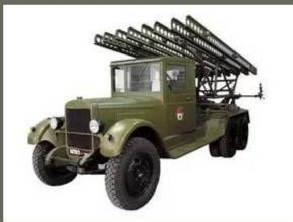
«Катюша» стала первой отечественной мобильной многозарядной реактивной системой залпового огня!!!! Дальность стрельбы – 8-8,5 км. Скорость БМ-13 по хорошей дороге достигала 50-60 км/ч. Всего 1-2 минуты требовалось для ее перевода из походного в боевое положение. На перезарядку после залпа уходило 3-5 минут, поэтому за час одна боевая машина могла сделать 10 залпов и выпустить 160 снарядов.
